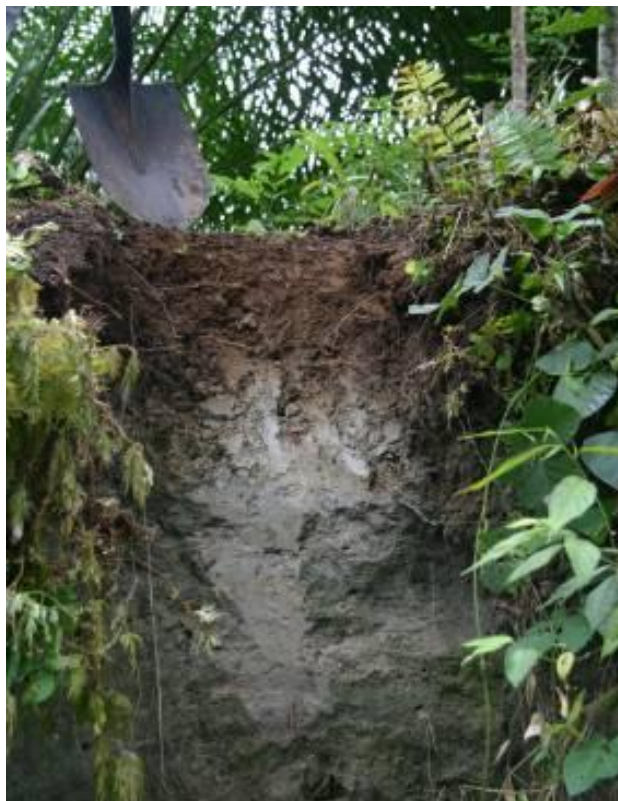
Foto 3. Suelos con limitación de uso por presencia de capa impermeable.
