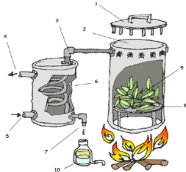
1. TAPA HERMÉTICA DE ACERO INOXIDABLE CON EMPAQUETADURA Y PERNOS TENSORES.
